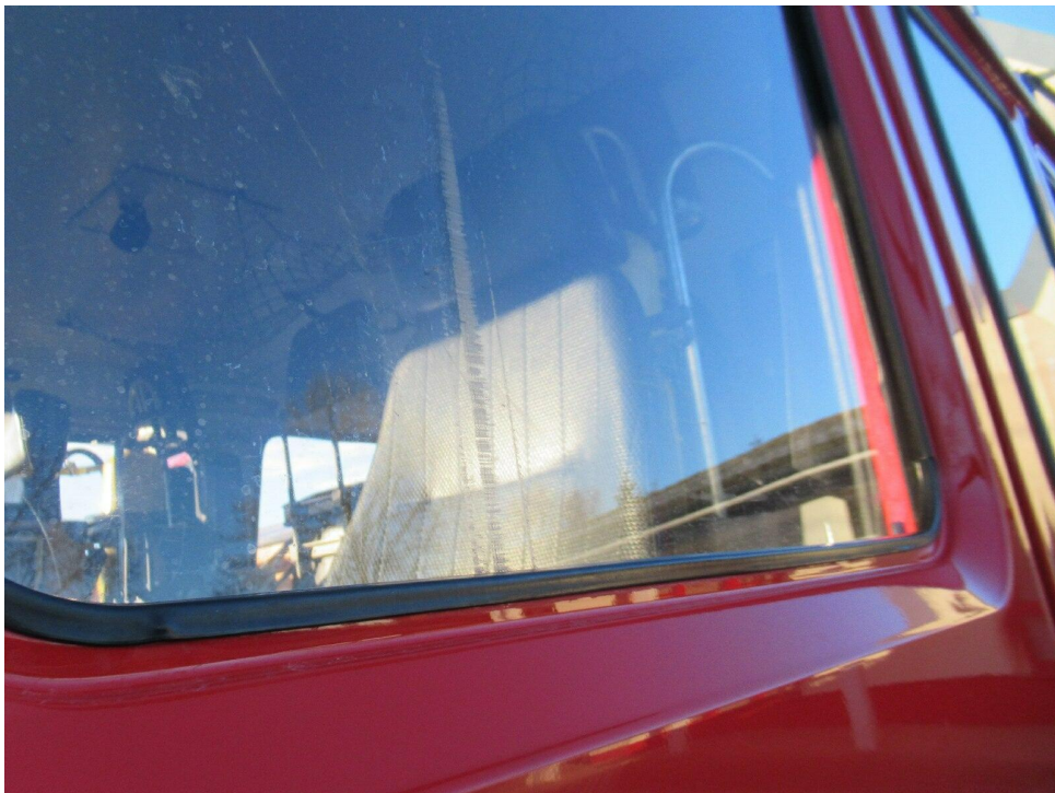
Bild 50 : Seitenscheibe links verschrammt
