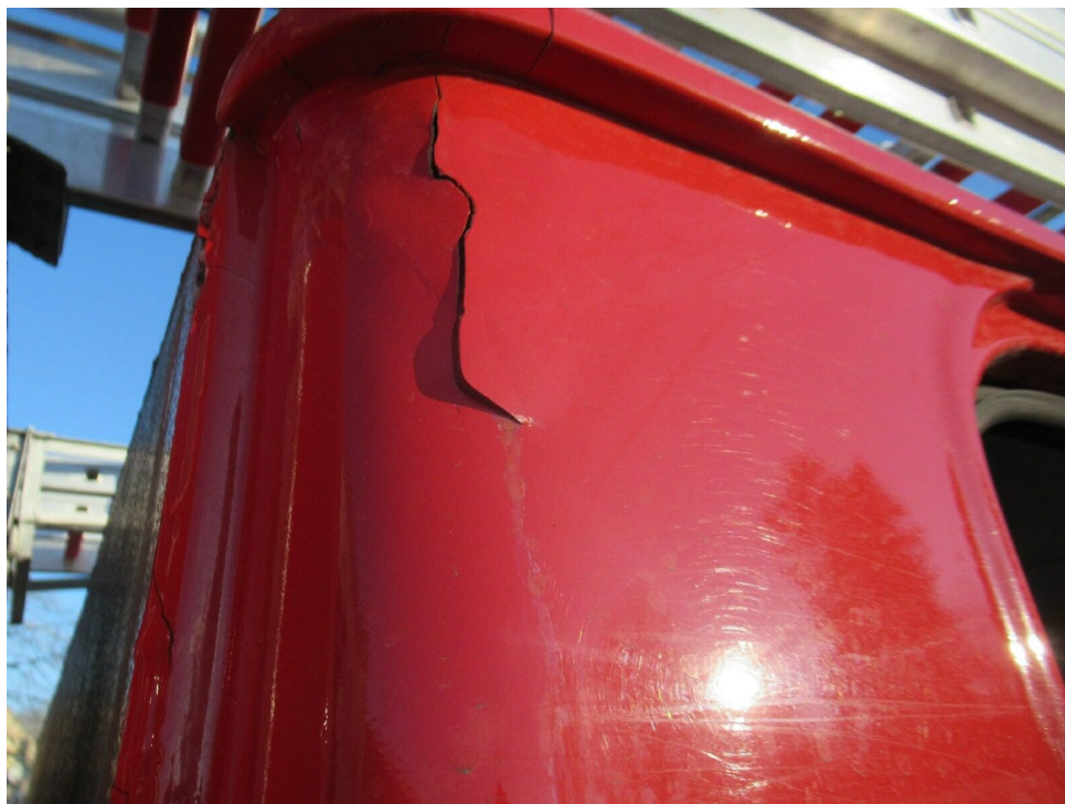
Bild 42 : Lackierung und Karosserie oben rechts beschädigt
