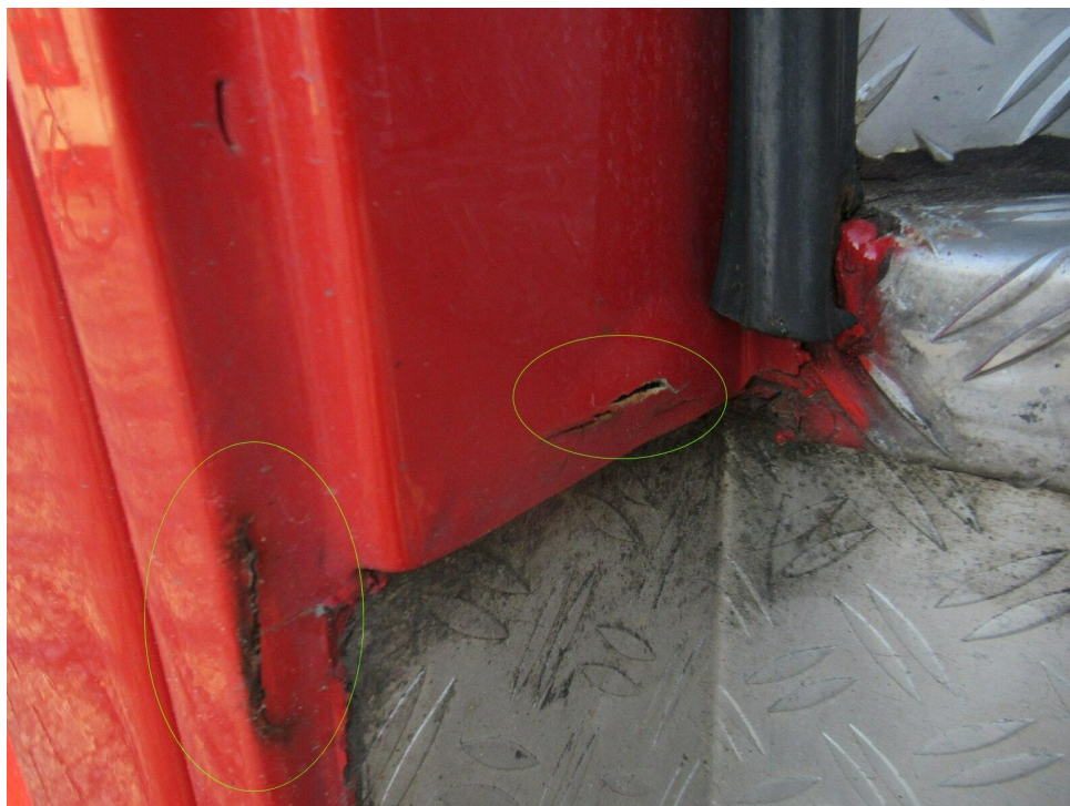
Bild 43 : Einstieg hinten rechts Beschädigungen
