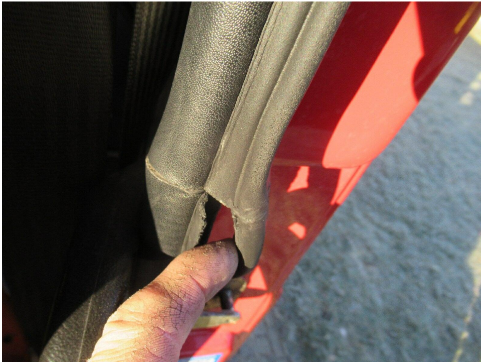
Bild 36 : Türdichtung vorne links beschädigt
