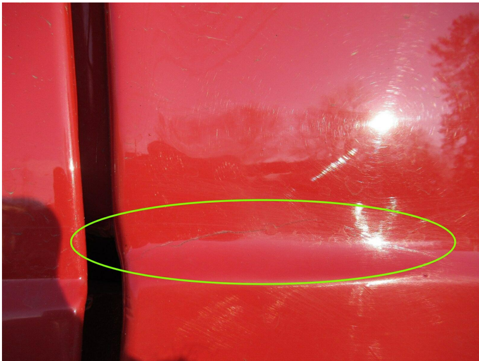
Bild 39 : Tür hinten links Lackierung gerissen
