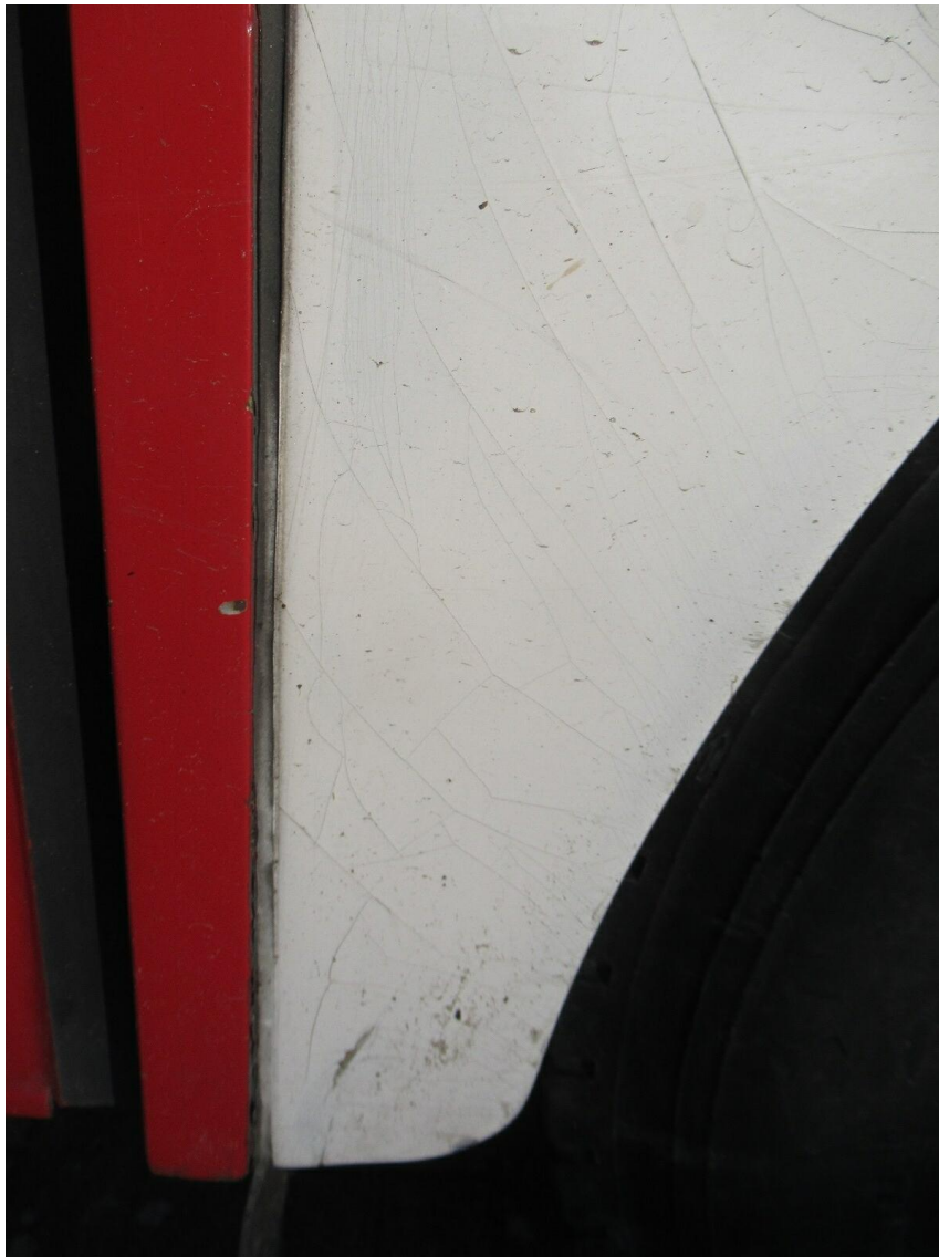
Bild 33 : Kotflügel hinten Lackierung gerissen
