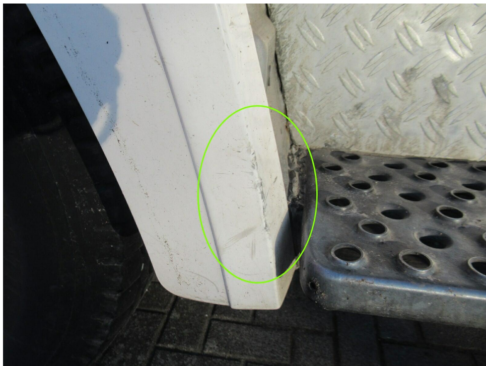
Bild 48 : Kotflügel links zerkratzt
