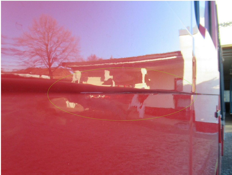
Bild 51 : Tür vorne links Lackierung gerissen
