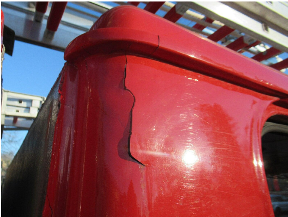
Bild 41 : Schadenübersicht Fahrerhaus hinten rechts oben
