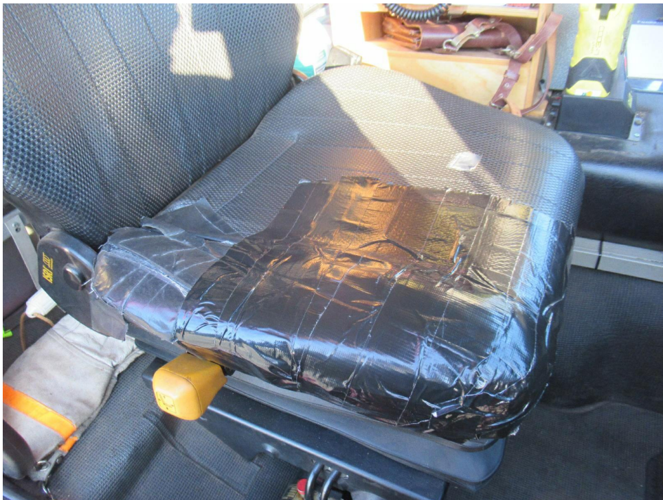
Bild 37 : Sitzkissen/Bezug vorne rechts beschädigt
