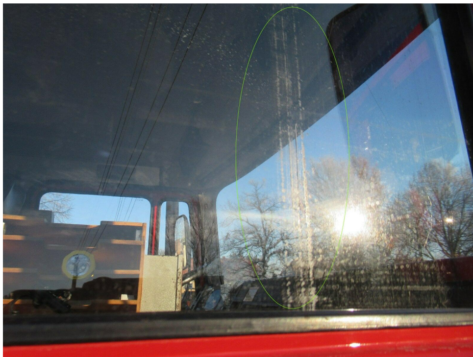
Bild 47 : Seitenscheiben vorne verschrammt
