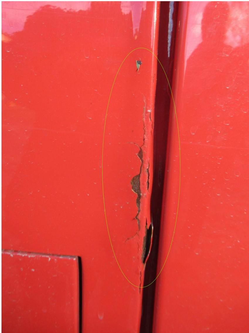
Bild 46 : Fahrerhaus hinten rechts unterhalb Beschädigung
