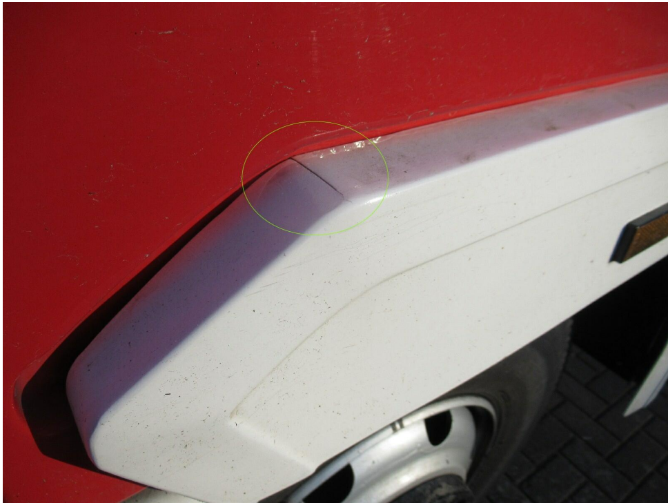
Bild 40 : Kotflügel vorne links eingerissen
