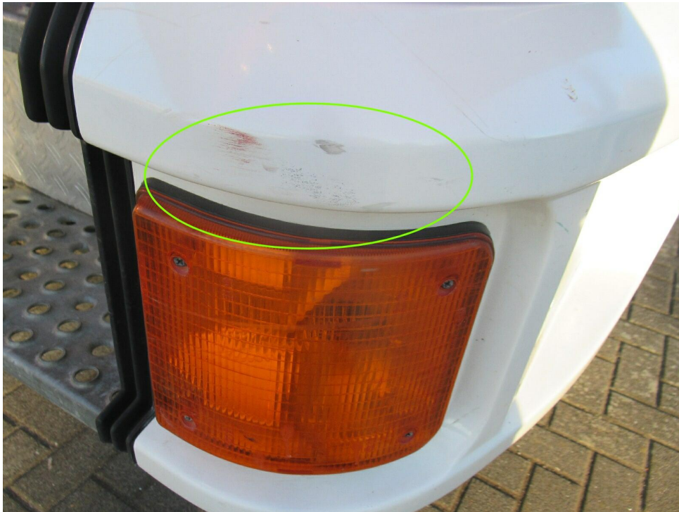
Bild 49 : Stoßfänger vorne verschrammt
